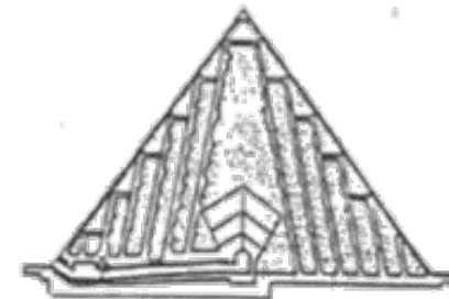
Sezione nord-sud della piramide di Sahure, Abusir Egitto
